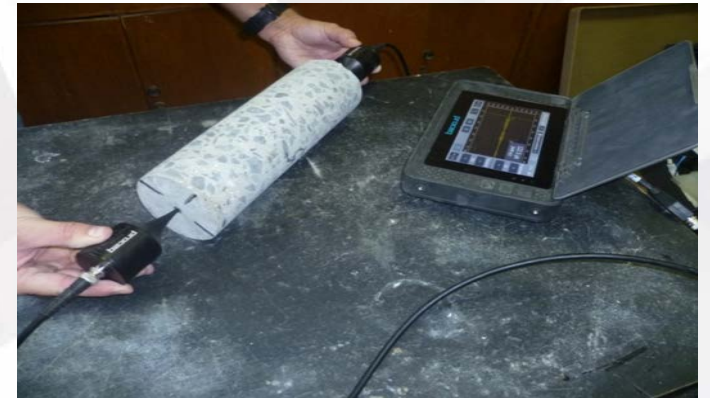
Определение скорости прохождения ультразвука прибором Pundit PL-200 с помощью экспоненциальных преобразователей 54 кГц
