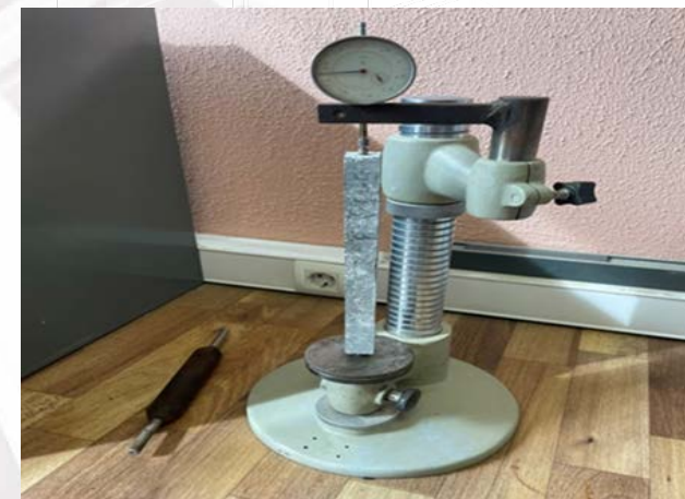
Определение относительных деформаций расширения с помощью индикатора часового типа 0,01 мм
