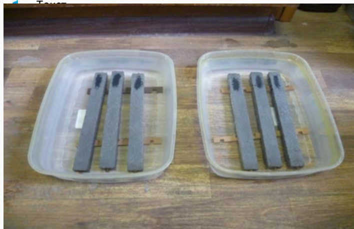
Образцы в условиях полного погружения в сульфатный раствор концентрации 34000 мг/дм 3 по иону \text{SO}_4^{2-} и в дистиллированную воду
