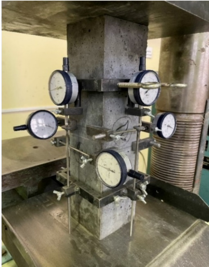
Определение начального модуля упругости и коэффициента Пуассона на образцах-призмах размером 100×100×400 мм по ГОСТ 24452
