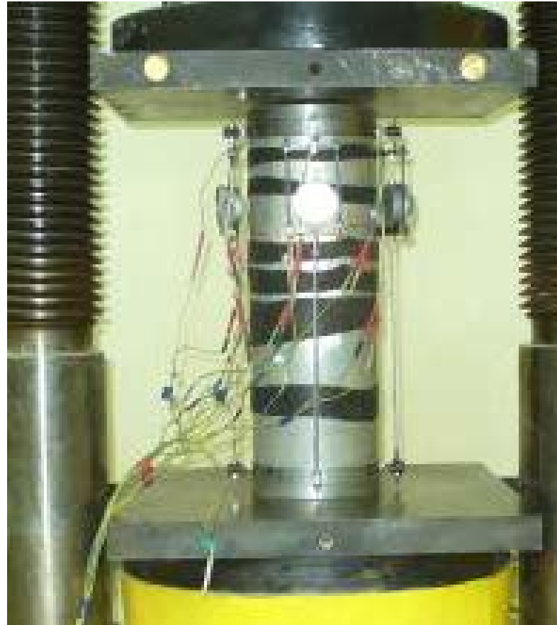
Построение полных диаграмм деформирования (включая нисходящую ветвь) на образцах-призмах размером 70,7×70,7×280,0 мм по специальной методике, разработанной в НИИЦ «МГСУ СТРОЙ-ТЕСТ»
