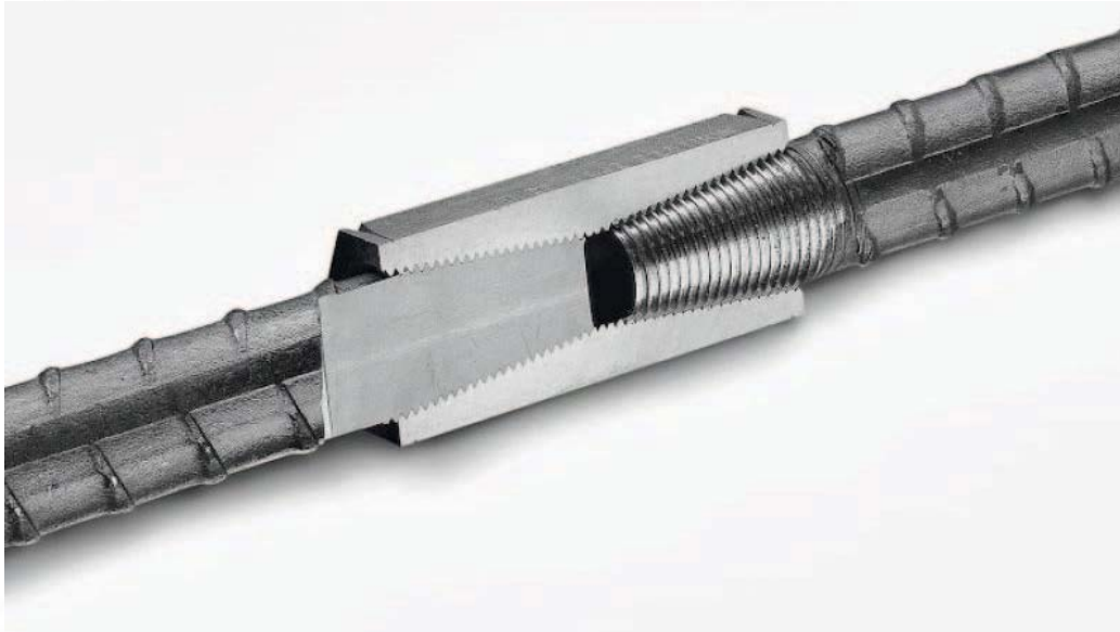
Резьбовое (нарезное) механическое соединение с нарезкой резьбы на концах арматуры
